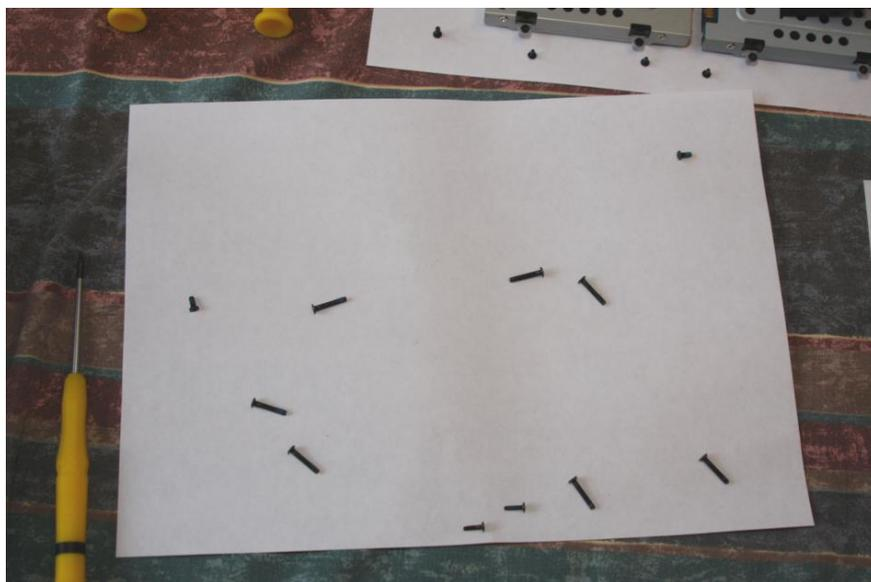
On peut maintenant retourner le pc et retirer la plaque du fond, retirer les deux disques dur en devisant les 8 petits vis (en rouge)
